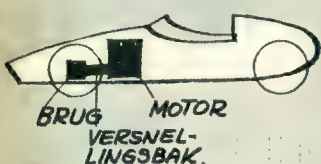
KLASSIEK : MOTOR VOORIN AANDRIJVING ACHTER .
